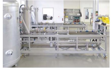
Sistema de calibración a pistón (2x) 20 ml/min – 1.200 l/min
