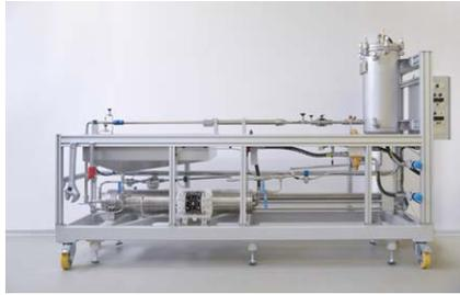
Sistema de calibración a pistón 10 ml/min – 200 l/min
